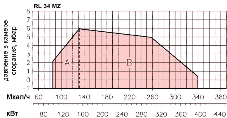
Горелки RL 34 MZ – RL 44 MZ могут работать в двух режимах: одноступенчатом и двухступенчатом.
